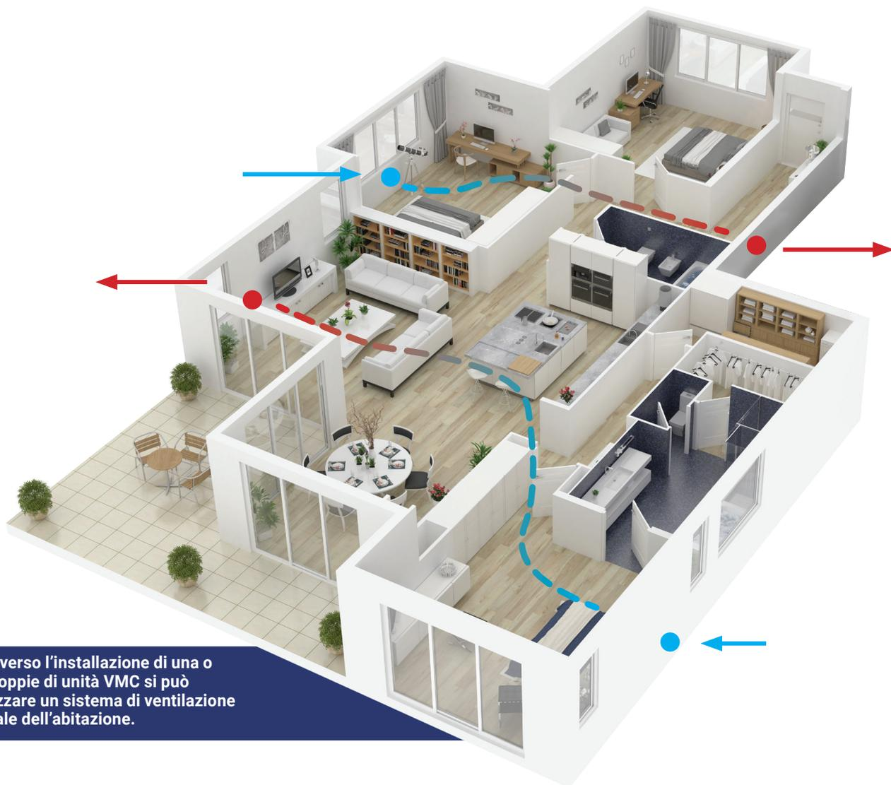
Attraverso l'installazione di una o più coppie di unità VMC si può realizzare un sistema di ventilazione globale dell'abitazione.
