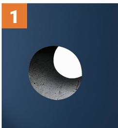
Realizzare un foro del diametro di 180mm con una leggera inclinazione dalla parete interna alla parete esterna (circa 1° ÷ 2°) in prossimità di una presa Schuko
